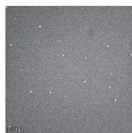
NutriCC®-NAD 50C 电镜图 粒径：~ 50nm
